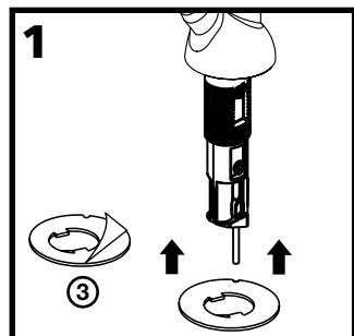
Localize a vedação adesiva (3). Remova o protetor de camada adesiva da parte superior da vedação e afixe-a na parte inferior do dosador. Remova o protetor de camada adesiva da parte inferior da vedação.
