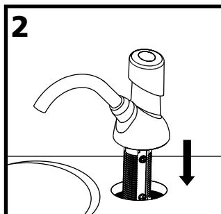
Posicione o sistema dosador direcionando a haste rosqueada para dentro do furo na superfície. Assegure-se que a calha esteja posicionada na direção da pia. Aperte firmemente o sistema dosador para garantir que ele esteja preso à superfície.
