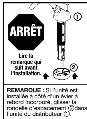
**REMARQUE :** Si l'unité est installée à côté d'un évier à rebord incorporé, glisser la rondelle d'espacement (2) dans l'unité du distributeur (1).
