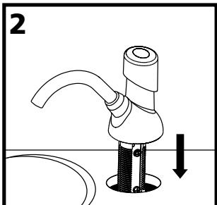
Placer le distributeur en orientant la douille filetée dans le trou du comptoir. S'assurer que le bec est en direction de l'évier. Appuyer fermement sur le distributeur pour bien le fixer au comptoir.
