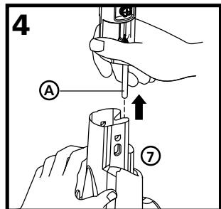
Alinee la varilla de metal (A) desde la espiga con el orificio de guía en el soporte de la botella (7). Deslice el soporte de la botella hasta la varilla.
