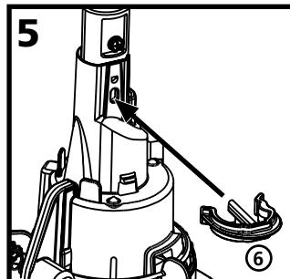
Prenda o suporte do frasco ao sistema dosador pressionando o clip retentor (6) até que ele se encaixe.
