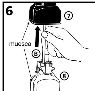
Coloque el tubo del dispensador (B)en la botella de la recarga (8) a través del soporte de la botella (6), alineando las dos muescas. Levante y deslice la recarga hasta que encaje.
