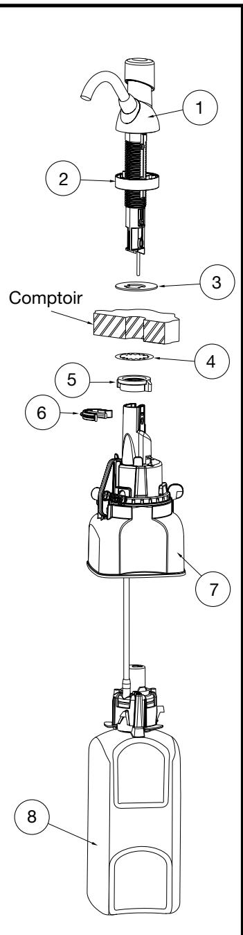
Insérer le tube du distributeur (8) dans la recharge (7) en passant par le support de bouteille (7), sans oublier d'aligner les deux renflements. Pousser la recharge vers le haut jusqu'à ce qu'elle clique en place.
