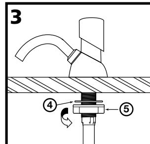
Sous le comptoir, fixer la rondelle de sécurité (4) et l'écrou de fixation (5) et les resserrer sous le comptoir.
