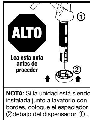
**NOTA:** Si la unidad está siendo instalada junto a lavatorio con bordes, coloque el espaciador (2)debajo del dispensador (1).
