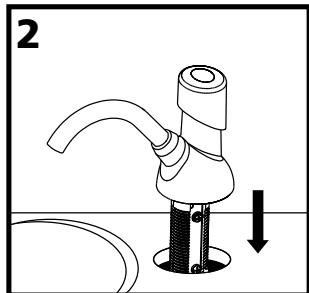
Posicione el dispensador guiando el tubo de enrosque dentro del agujero del mostrador. Asegúrese que el surtidor apunte hacia el lavatorio. Presione firmemente el dispensador para asegurarse que esté sujeto al mostrador.
