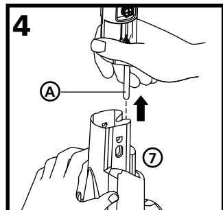
Alinhe a vareta de metal (A) da haste rosqueada com o pequeno orifício de guia no suporte do frasco (7). Levante e deslize o suporte do frasco através da vareta.
