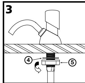
Desde debajo del mostrador, ajuste la arandela de seguridad(4) y la tuerca de montaje (5).
