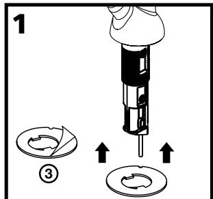
Prendre le joint adhésif (3). Décoller le papier protecteur au-dessus du joint adhésif et coller le joint au bas du distributeur. Retirer le papier protecteur sous le joint adhésif.
