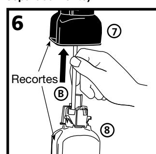
Coloque o tubo dosador (B) no frasco de refil (8) através do suporte do frasco (7), alinhando as duas partes para o encaixe. Levante e deslize o refil até que ele se encaixe.
