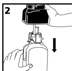
Tout en poussant sur le système de déblocage, tirer sur la bouteille et la retirer du support de bouteille.
